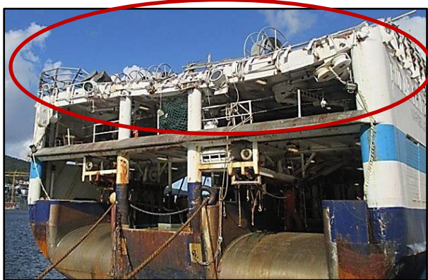
Avaries AR du pont supérieur du PRINCESS, à quai à Jekteviken 1 après l'abordage - Photo GeofieLD.
