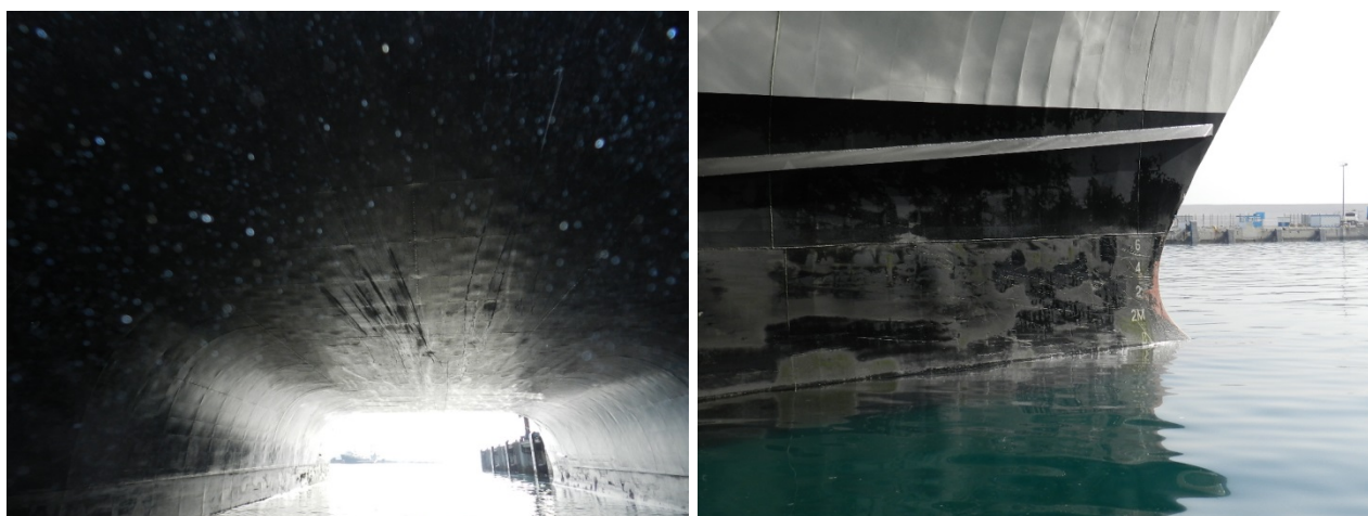
Figura 7. Arañazos en el túnel y casco de babor del B/RP MARIA DOLORES
