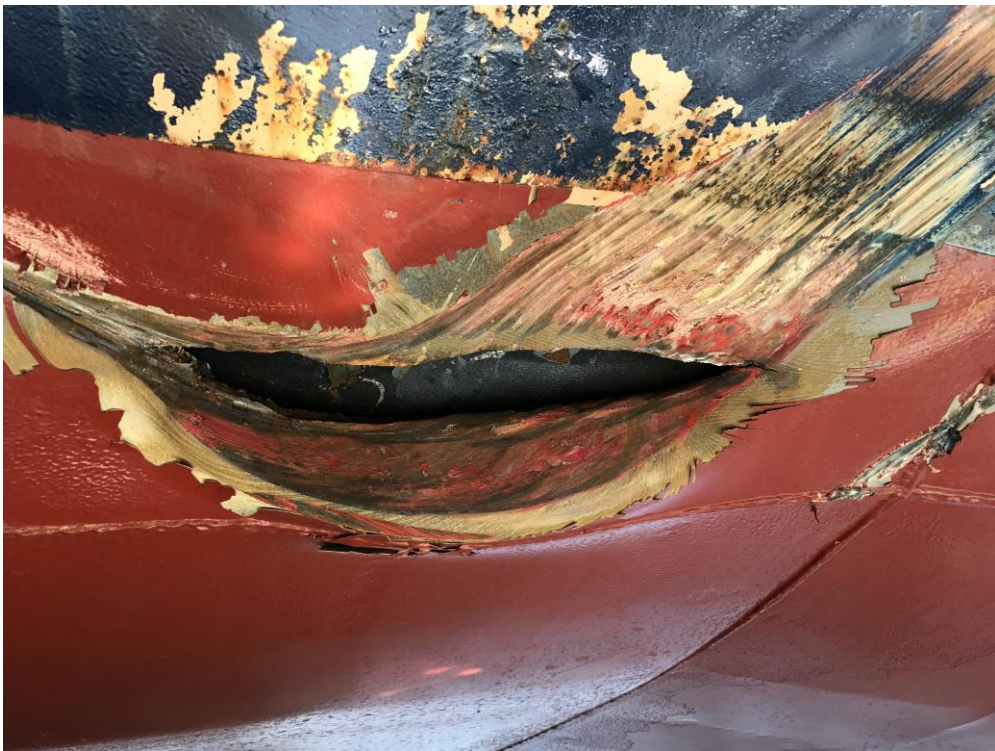
Slika 24: Poškodba krmnega dela ladje "NEPTUNE THELISIS"
