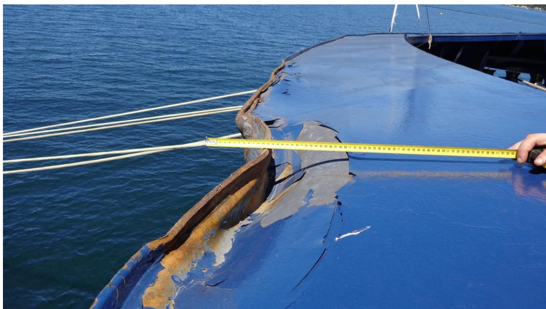
Slika 28 Poškodba na levi strani premca »NETUNE THELISIS« (Vir: DNV-GL)
